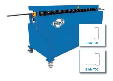
Cette machine à former à galets 14 positions crée une bride rigide TDC ou TDF à partir des tôles alimentées à la main en utilisant les matériaux du bord de la gaine.
